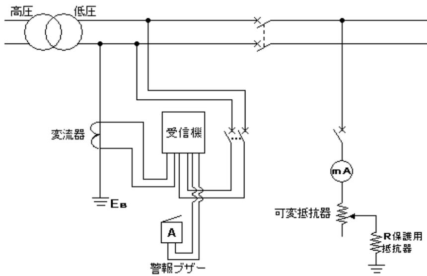
第 13-7 図 検出漏えい電流値検査方法例 2
