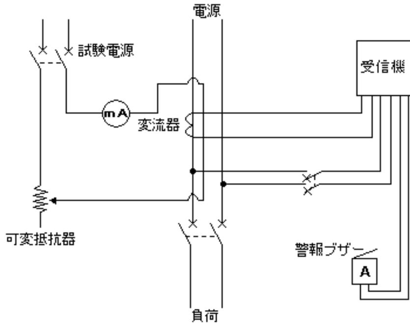
第 13-6 図 検出漏えい電流値検査方法例 1
